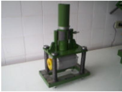
Figura 4.5 – Mesa vibratória para densificação do material semi-sólido
