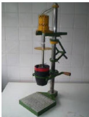
Figura 4.1 – Máquina para elaboração de materiais compósitos por re fundição
