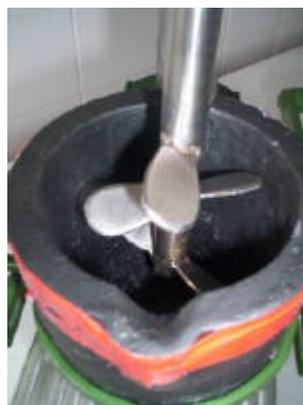
Figura 4.2 – Conjunto de hélices do agitador mecânico
