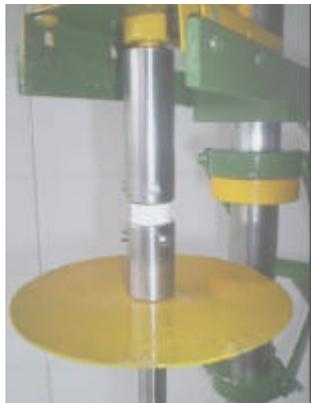
Figura 4.3 – Detalhe da máquina mostrando o eixo com defletor de calor e a coluna com os anéis limitadores
