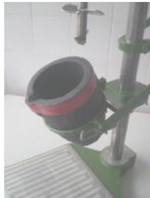
Figura 4.4 – Detalhe da máquina mostrando o basculamento do cadinho para possibilitar o vazamento da liga
