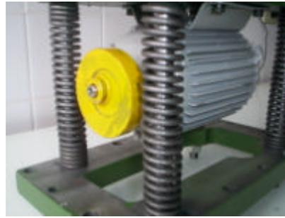
Figura 4.6 – Polia excêntrica para variação da amplitude de vibração
