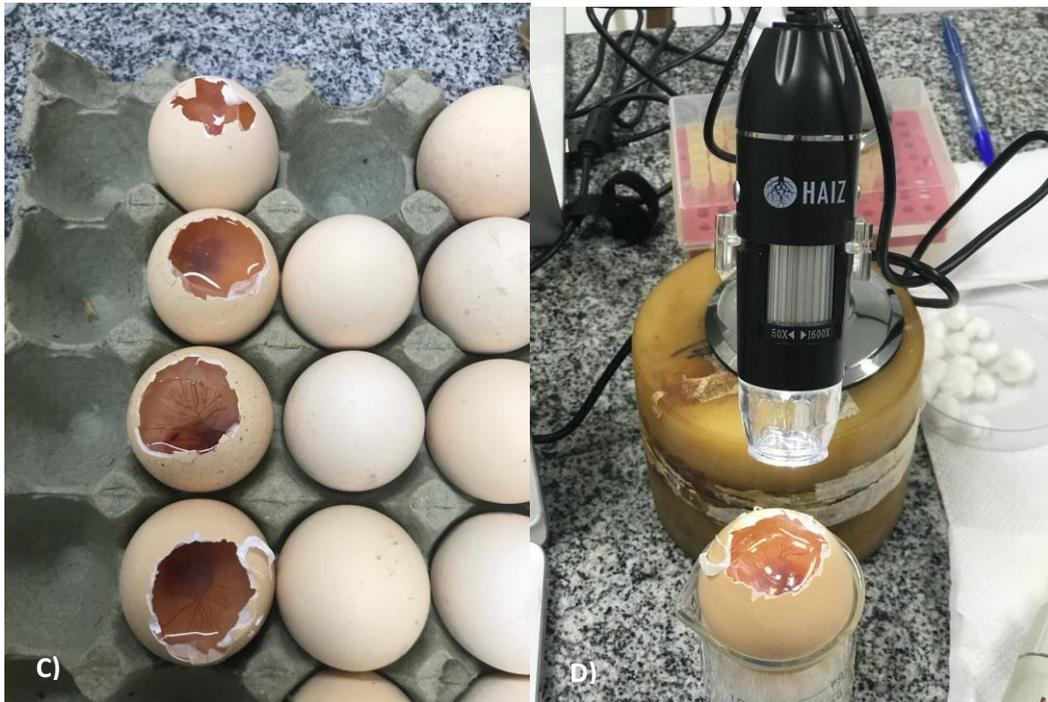
Legenda: A) Corresponde a quebra cautelosa da casca do ovo; B) Umedecimento da membrana com soro fisiológico; C) Membranas expostas para receber as amostras; D) Análise microscópica.
