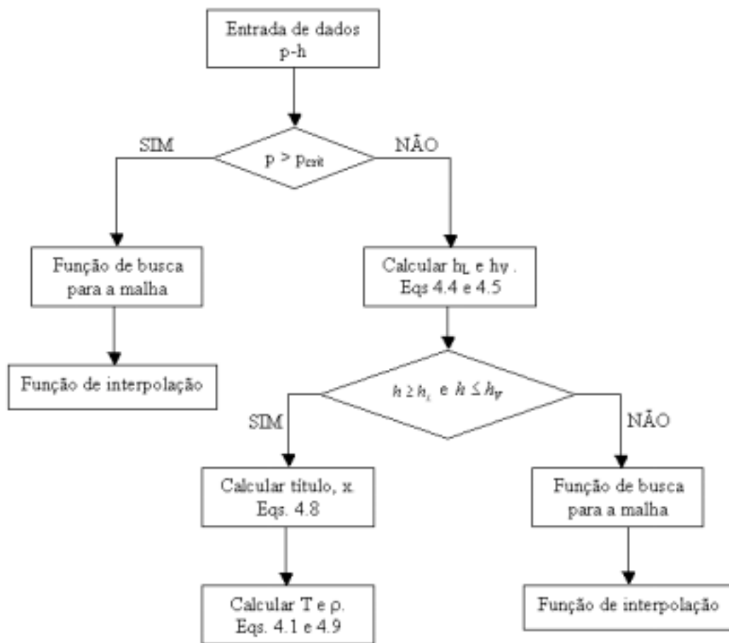
Figura 4.3 – Esquematização do algoritmo usado para calcular uma propriedade termodinâmica ao longo da malha.
