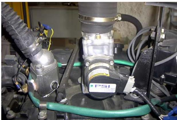
Figura 6 – Controlador de Velocidade de aspiração
