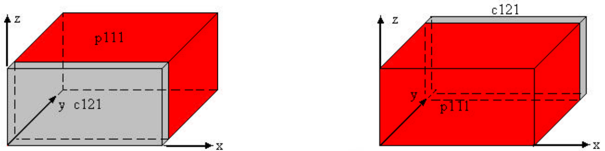
Figura 5.4 (b) – Fresamento plano tangencial dos sobre-metais “FRONT” E “REAR”.
