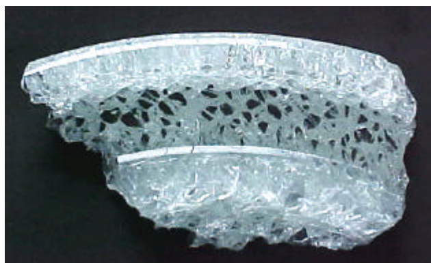
Figura 4.11 – Foto de um fragmento trincado do isolador elétrico de vidro temperado.
