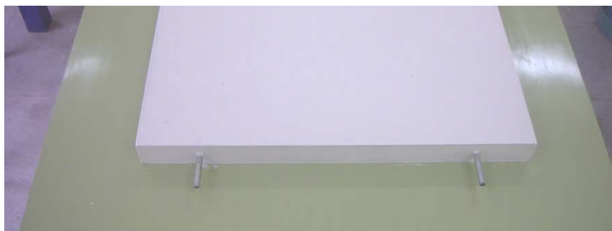
Figura 5.28 – Sistema de fixação das placas.
