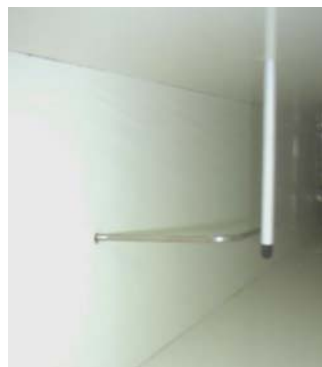
Figura 5.37(a e b) – Medidor de unidade e temperatura de ar interno do túnel.
