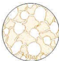
Figura 3.6 –Desenho de corpo poroso, onde se vê a estrutura dos poros e capilares.
