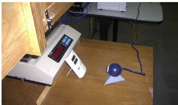
Figura 5.39 – Posicionamento do higrótermógrafo e a webcam.
