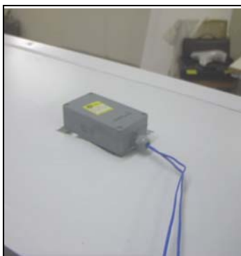
Figura 5.37(a e b) – Medidor de unidade e temperatura de ar interno do túnel.
