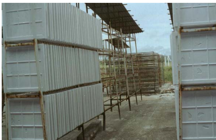
Figura 2.1 – Secagem de placas de gesso ao ar livre utilizada no pólo gesseiro do Araripe em Pernambuco.
