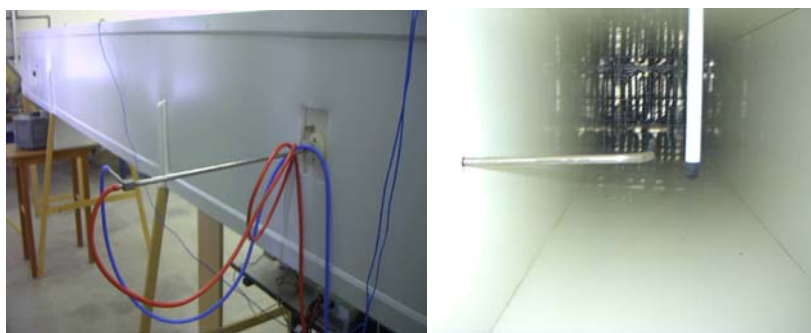
Figura 5.46 (a e b) – Detalhe do posicionamento do tubo pitot.
