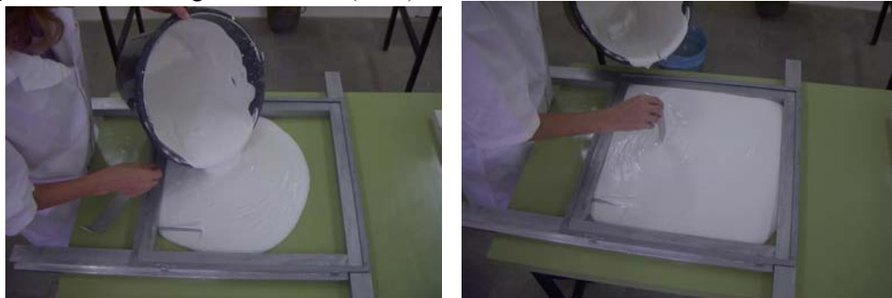
Figuras 4.7 (a e b) – Momento da moldagem das placas
