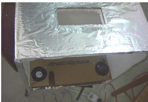
Figura 5.42 – Detalhe do Isolamento da balança
