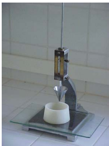
Figura 4.3 – Detalhe do aparelho Vicat modificado.
