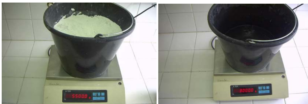
Figura 4.5(a e b) – Detalhe da masseira para o preparo da pasta de gesso.
