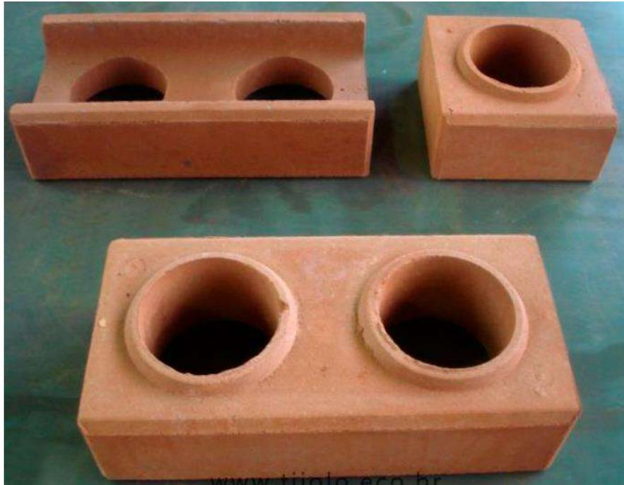
Figura 33: Canaleta, meio-tijolo e tijolo padrão em solo-cimento.
