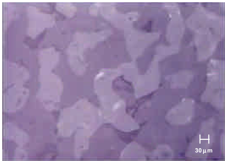
Figura 4.34 – Microscopia óptica referente aos compostos \text{Ba}_2\text{HoZrO}_{5.5} com 2% CuO através do processo direto. Com uma aumento de 300 vezes.
