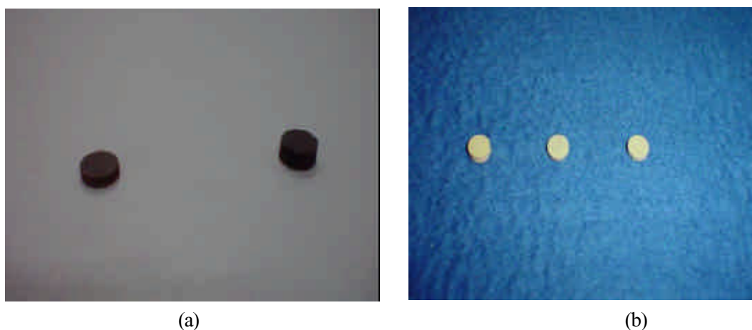
Figura 3.9 - Pastilhas cerâmicas \text{Ba}_2\text{HoZrO}_{5,5} compactadas e sinterizadas. (a) \text{Ba}_2\text{HoZrO}_{5,5} 1% e 2%CuO (da esquerda para direita) a uma temperatura de 1250^\circ\text{C} durante 48h, (b) \text{Ba}_2\text{HoZrO}_{5,5} com 0-2% CuO (da esquerda para direita) compactadas e sinterizadas a uma temperatura de 1600^\circ\text{C} durante 48h através do processo direto.
