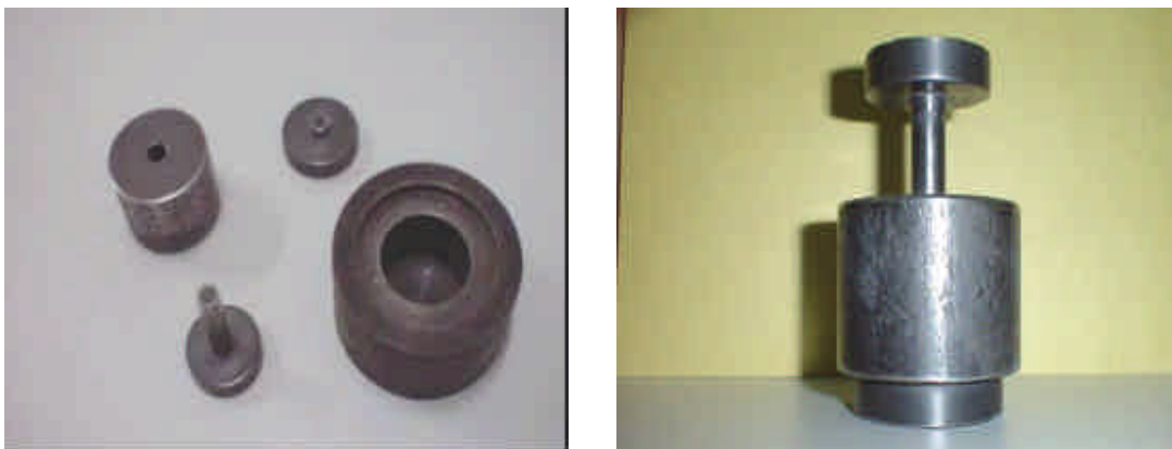
Figura 3.2- Moldes metálicos utilizados para obter pastilhas cerâmicas.
