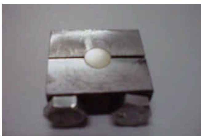
Figura 3.10 - Dispositivo empregado para fixação das amostras em estudo para realização da MHv.
