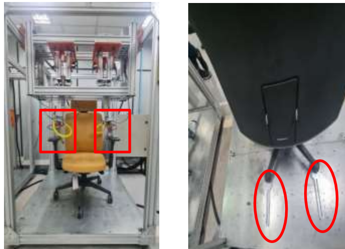
Figura 91 – Representação do método – Durabilidade no apoio-braço
