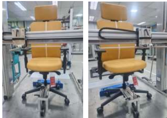
Figura 44 – Representação do método – Largura útil do encosto (i)
