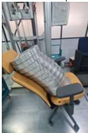
Figura 74 – Representação do método – Desequilíbrio para trás em cadeiras reclináveis
