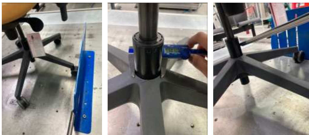
Figura 58 – Representação do método – Projeção da pata (s)
