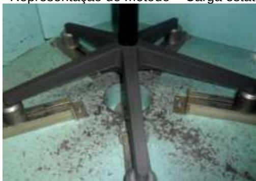
Figura 94 – Representação do método – Carga estática na base
