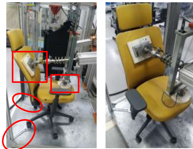
Figura 87 – Representação do método – Durabilidade no assento e encosto para cadeira giratória operacional – Pontos de Carregamento J e E
