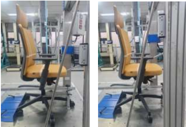
Figura 52 – Representação do método – Recuo do apoia-braço (q)
