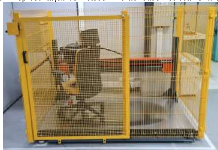
Figura 96 – Representação do método – Durabilidade Deslocamento de rodízios
