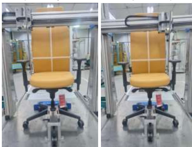
Figura 36 – Representação do método – Largura da superfície do assento (d)
