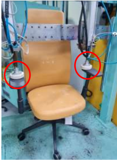
Figura 81 – Representação do método – Carga estática vertical no apoia-braço – Central
