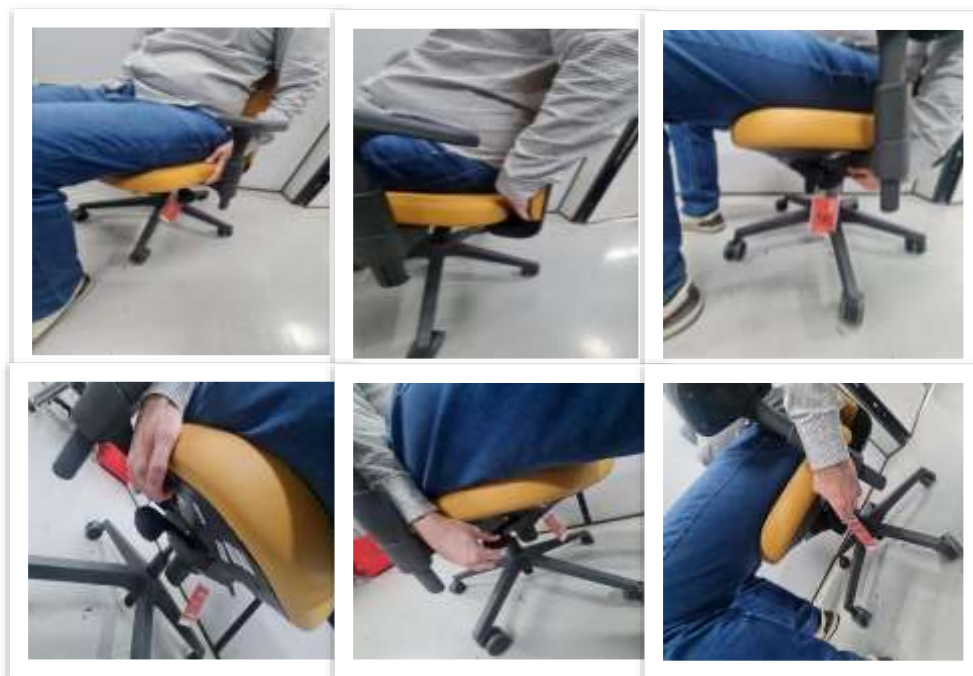
Figura 20 – Partes acessíveis da cadeira giratória operacional
