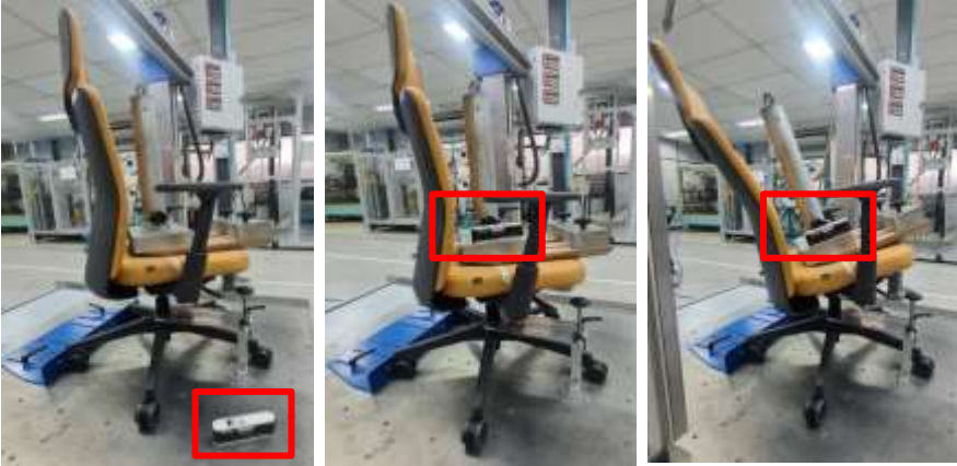
Figura 62 – Representação do método – Ângulo de inclinação do assento (e)
