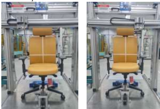
Figura 50 – Descrição do método – Distância interna entre os apoia-braços (r)
