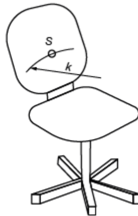
Figura 45 – Raio de curvatura do encosto (k)
