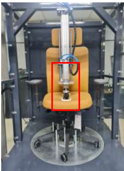
Figura 92 – Representação do método – Rotação
