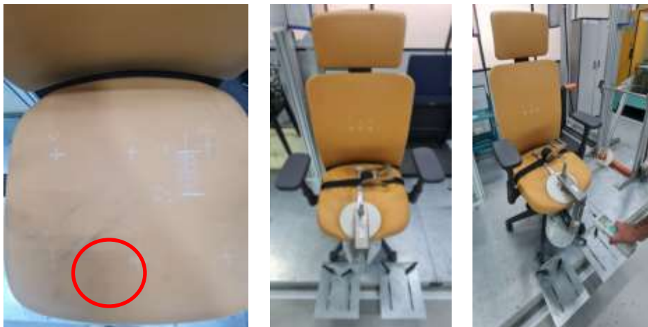
Figura 70 – Representação do método – Desequilíbrio para frente
