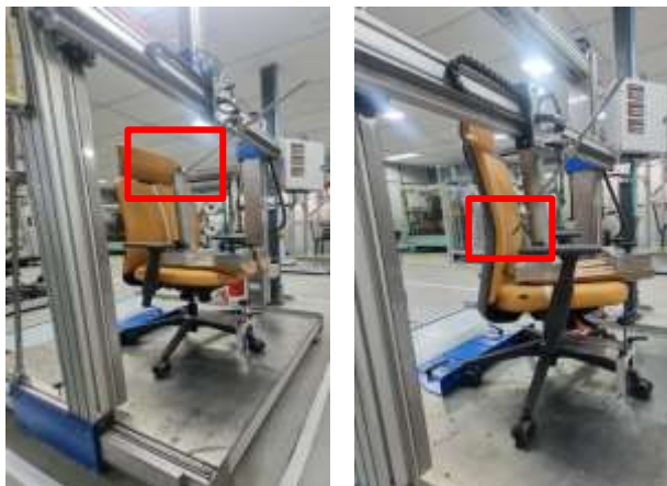
Figura 64 – Representação do método – Altura do ponto S do encosto (intervalo de regulagem) (f)
