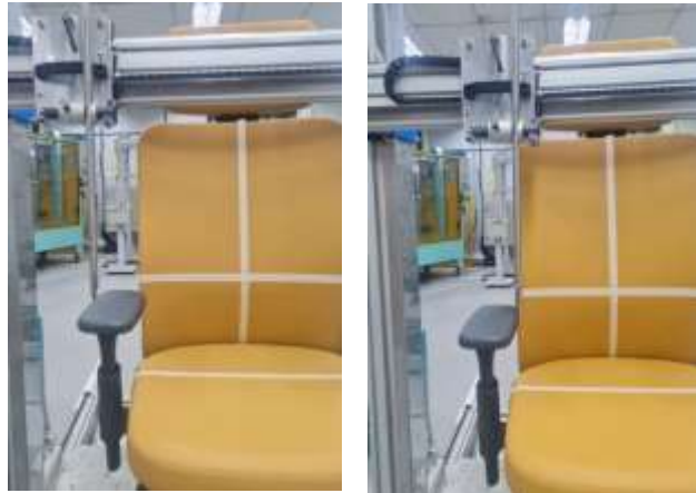
Figura 56 – Representação do método – Largura da área útil do apoia-braço (o)
