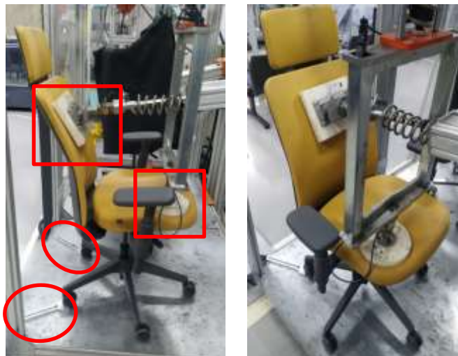
Figura 88 – Representação do método – Durabilidade no assento e encosto para cadeira giratória operacional – Pontos de Carregamento F e H
