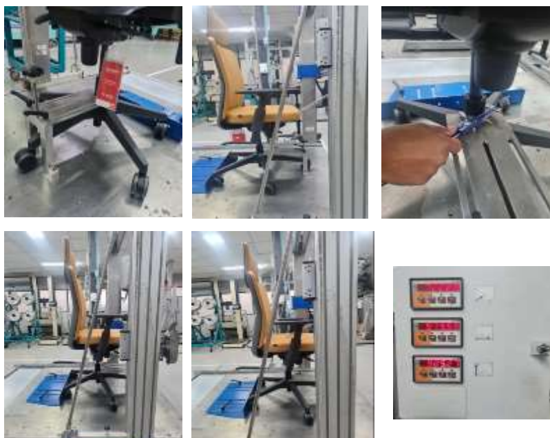
Figura 33 – Representação da determinação do ponto A do assento
