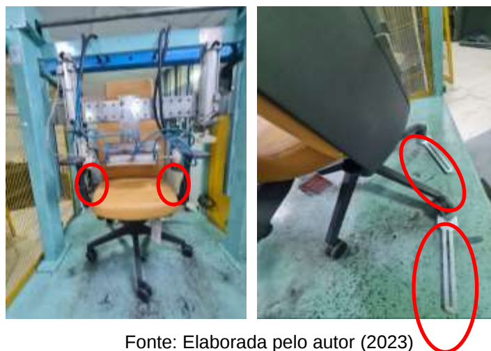
Figura 84 – Representação do método – Carga estática horizontal no apoia-braço
