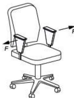
Figura 83 – Carga estática horizontal no apoia-braço
