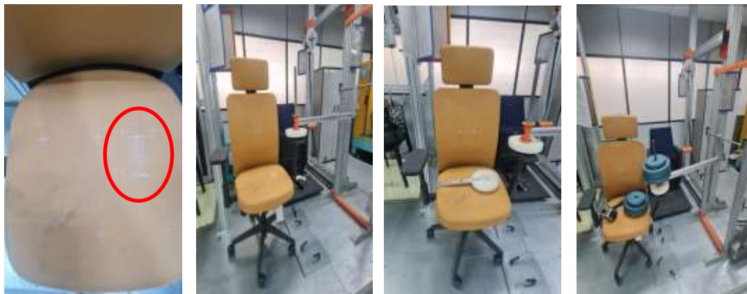
Figura 72 – Representação do método – Desequilíbrio para os lados em cadeiras com apoia-braços
