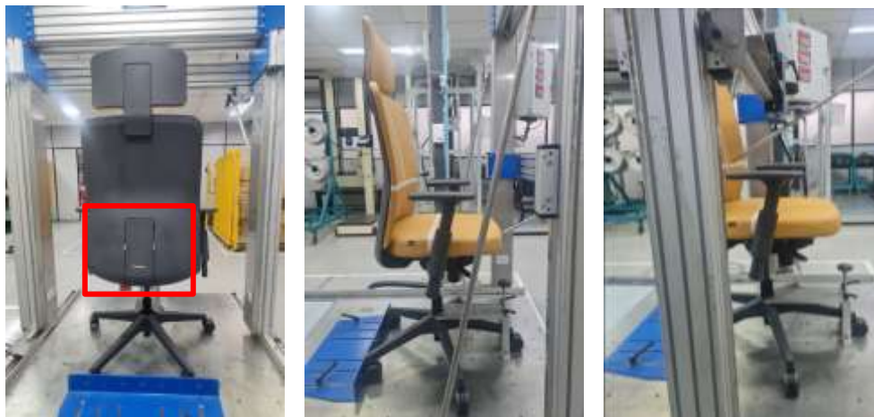
Figura 40 – Representação do método – Profundidade da superfície do assento (d)
