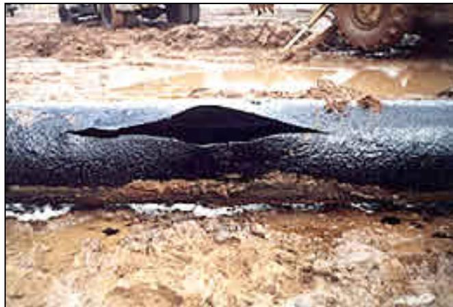
Figura 2.3 – Oleoduto rompido por corrosão em Campinas-SP.
