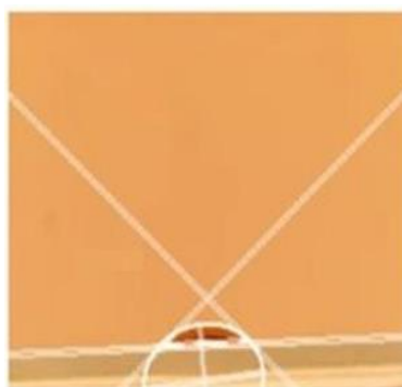
Figura 25 - Ângulo de contato de 35,4 ° uma gota de solução precursora em contato com membrana porosa de alumina.
