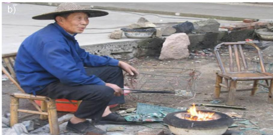
**Figura 4.2:** b) Combustão de placa de circuito eletrônico para recuperação de metais utilizados na peça em Taizhou, China.
