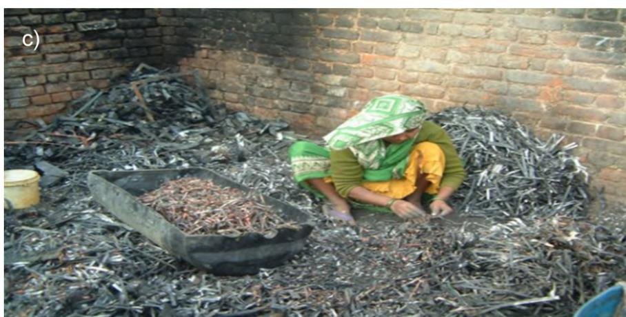
**Figura 4.3:** c) Após a combustão, separação manual dos fios de cobre de um circuito eletrônico em Nova Delhi, Índia.
