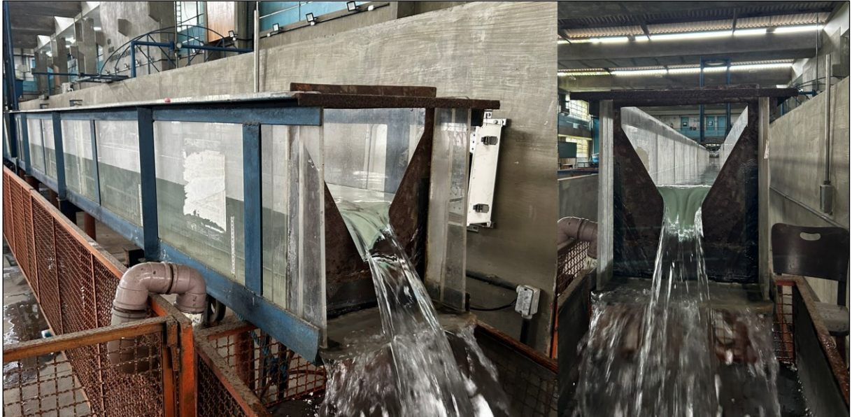
Figura 30 – Vertedor Triangular de Chapa Metálica para Medição de Vazão
