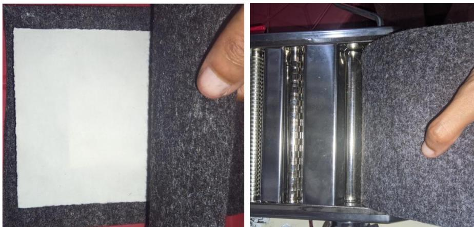
**Figuras 22. Colocado o carpete por cima, formando o "sanduíche", em seguida foi ajustado e passado nos rolos da máquina culinária.**
