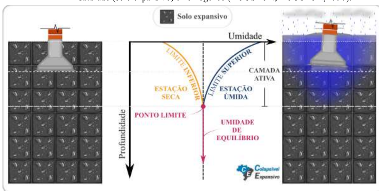
Figura H.2 - Representação esquemática das variações sazonais da umidade em um perfil de solo não saturado (solo expansivo) e homogêneo (HOUSTON; HOUSTON, 1997).
