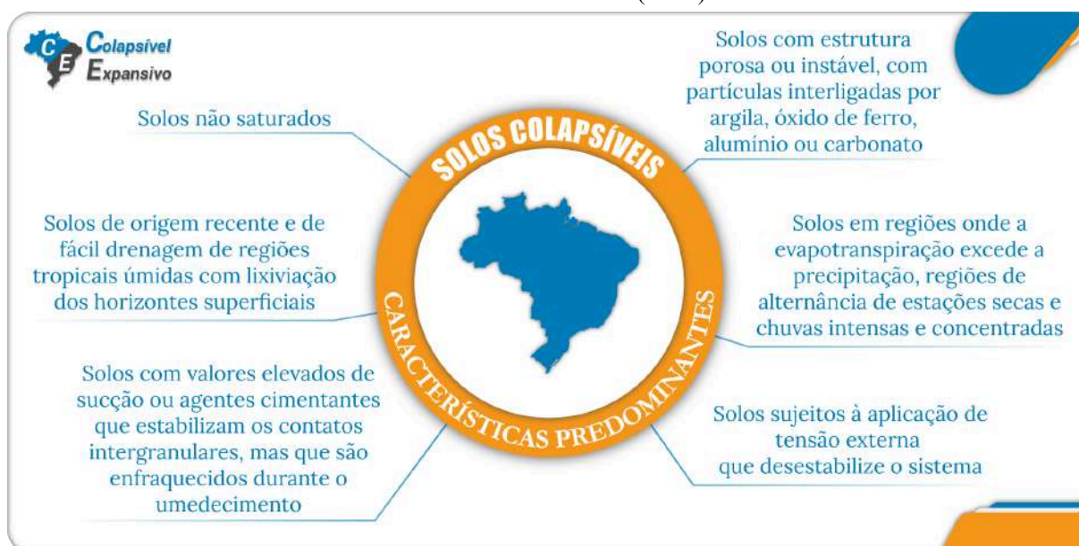
Figura 3 - Características predominantes nos solos colapsíveis, segundo Vilar e Ferreira (2015) e Barden et al. (1973).
