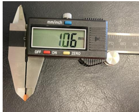
Figura 8- Paquímetro realizando a calibração do disco de cimento
