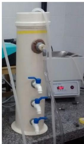
**Figura 3.4:** Reator tipo UASB, em escala de laboratório.
