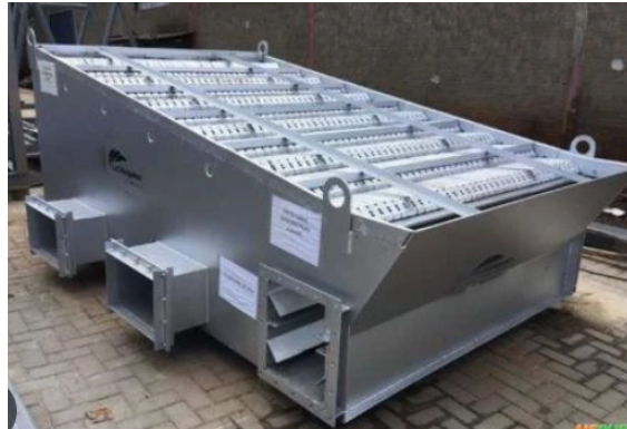
Figura 3.4 - Grelha móvel para caldeiras.
