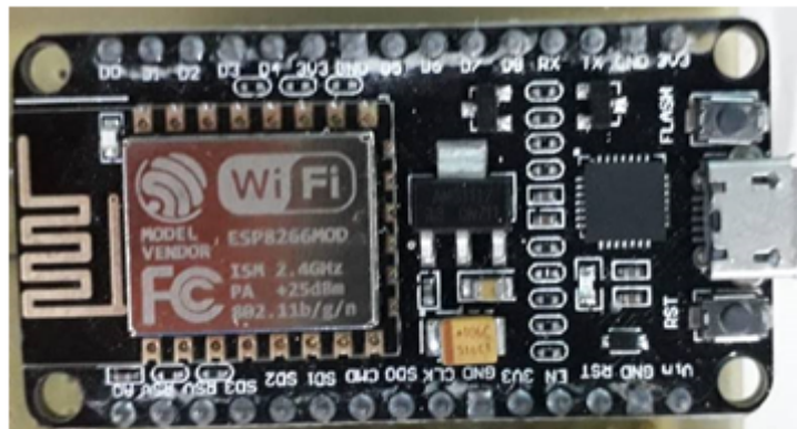
Figura 18 – ESP8266. Fonte: Própria.
