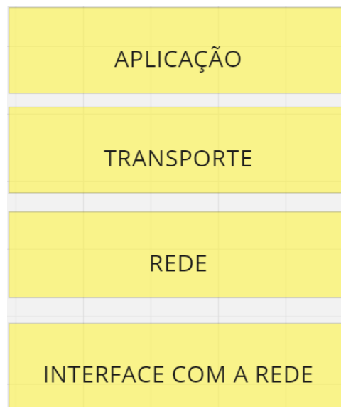
Figura 5 – Camadas TCP/IP. Fonte: Adaptado de Torres (2014)
