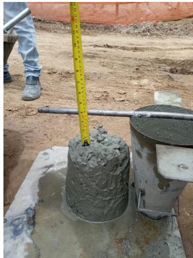
Figura 8 – Ensaio de abatimento do tronco de cone
