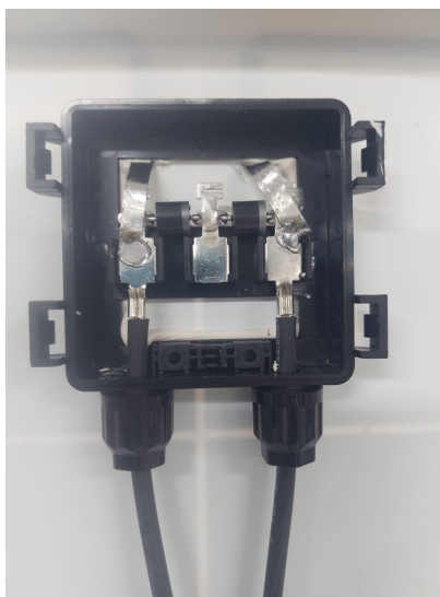
Figura 53 – Detalhe da caixa de junção de um dos módulos ensaiados do tipo RSM-100P.
