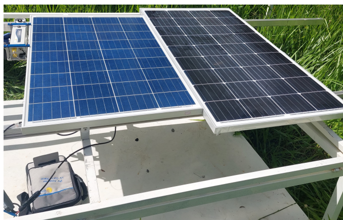
Figura 37 – Bancada experimental externa para ensaios de módulos FV.
