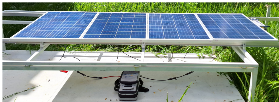
Figura 62 – Bancada experimental para extração de curvas com arranjo de quatro módulos RSM-100P.
