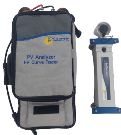
Figura 33 – Extrator de curvas - PV Analyzer I-V Curve Tracer - PVA 1000S e o sensor de irradiância, temperatura e inclinação sem fio SolSensor .
