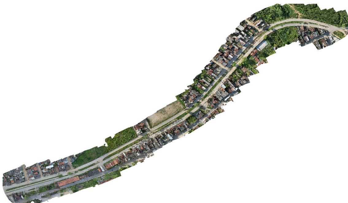
Figura 5 – Ortomosaico gerado no DroneDeploy
