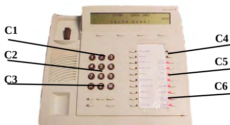
Figura 6.13 – Localização sobre botões e teclas do aparelho de distribuição automática de chamadas (DAC) dos pontos onde foi posicionado o luxímetro, durante a realização das medições.
