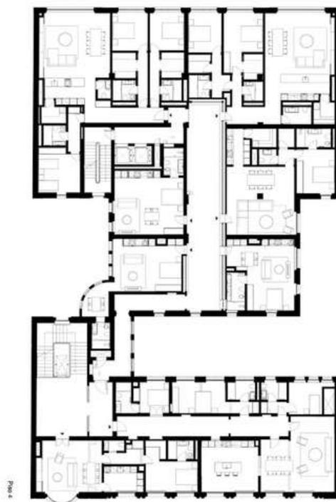
Figura 32 - Planta Baixa do 4º pavimento.
