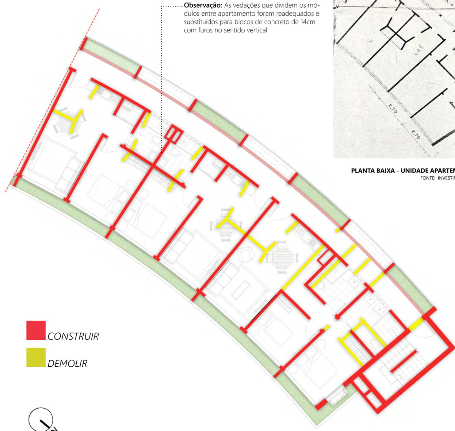
**Observação:** As vedações que dividem os módulos entre apartamento foram readequados e substituídos para blocos de concreto de 14cm com furos no sentido vertical
