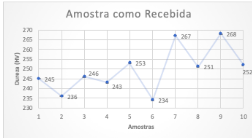
Figura 27: Resultados do teste microdureza amostra como recebida
