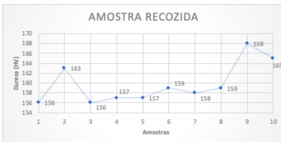
Figura 28: Resultados do teste microdureza amostra recozida
