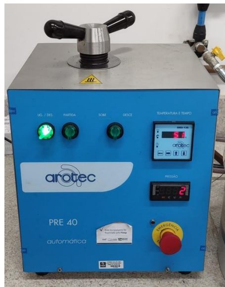
Figura 16 - Máquina utilizada para realizar o embutimento das amostras.
