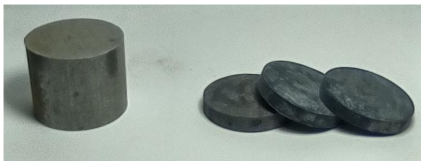
Figura 12 - Exemplo das amostras geradas a partir do corte dos tarugos de aço.
