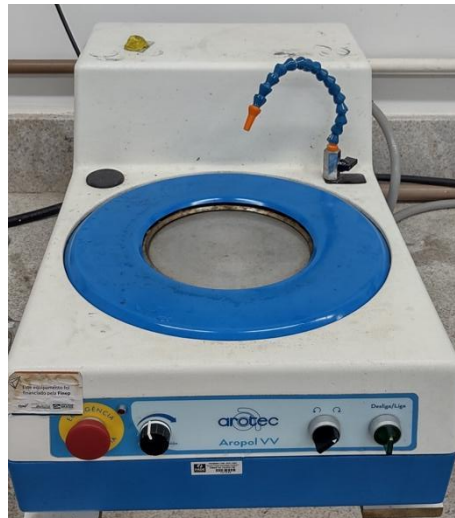
Figura 18 - Máquina de lixamento tipo marca utilizada para o lixamento das amostras.
