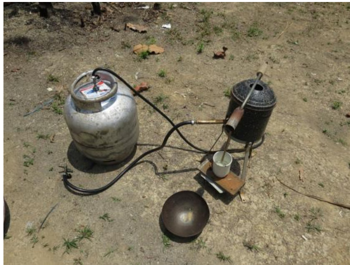
Figura 1 – Fotografia de destilador e queimador a gás para realizar amálgama, na comunidade de Tapajós- AM
