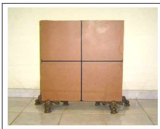
Figura 6.3: Referencial de 500x500 mm para calibração da fotografia utilizado na pesquisa.
