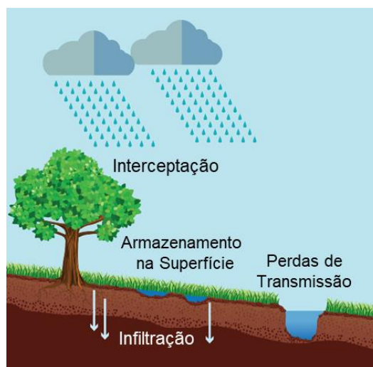
Figura 42 – Principais processos físicos de perdas de precipitação no balanço hídrico.
