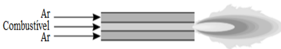
Figura 10 – Esquema de um queimador de mistura por difusão
