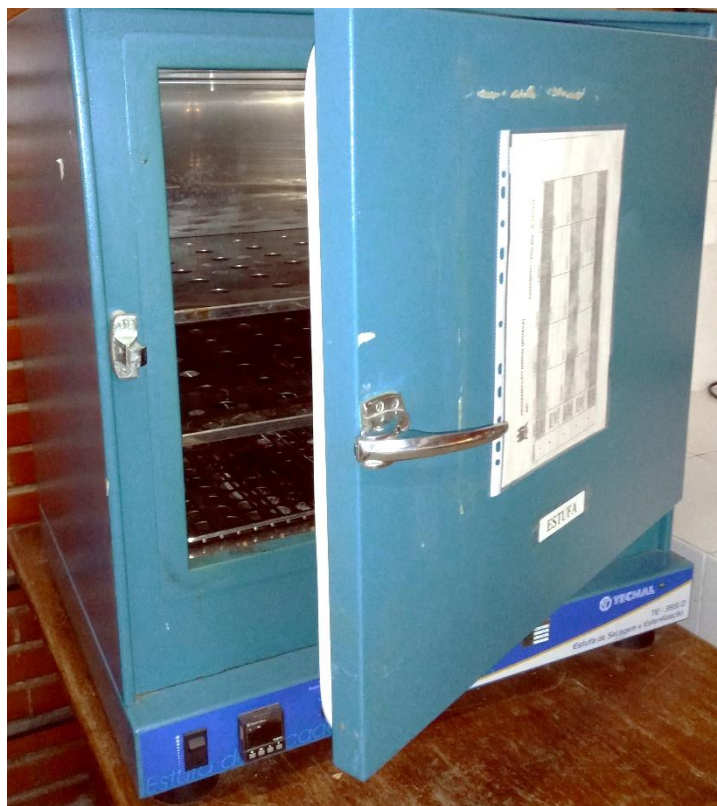
Figura 27: Estufa TECNAL TE-393, usada nas análises umidade e extrato seco das amostras de mel, mosto e hidromel.
