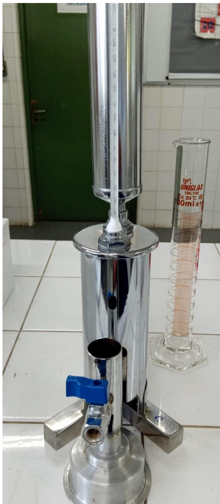
Figura 34: Ebuliometro usado na análise de teor alcoólico do hidromel H, C1 e C5.
