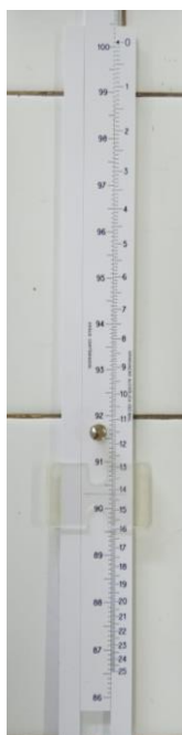
Figura 35: escala de conversão °C para °GL do ebuliometro.
