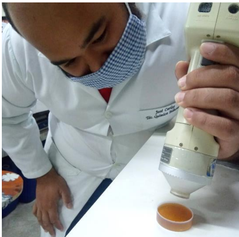
Figura 25: análise de cor com auxílio de colorímetro portátil MINOLTA CR-400, usado nas amostras de mel, mosto e hidromel.
