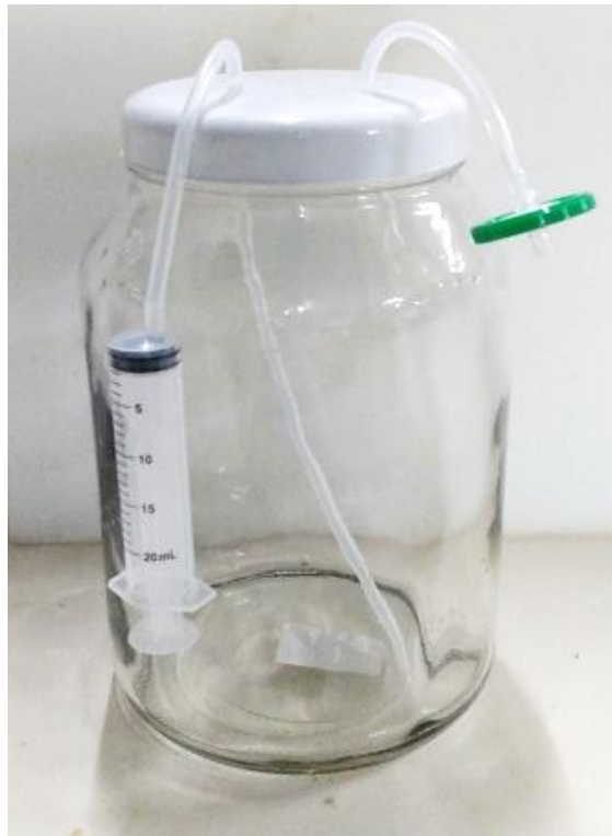
Figura 6: Fermentador com seringa, mangueira e filtro para seringa.
