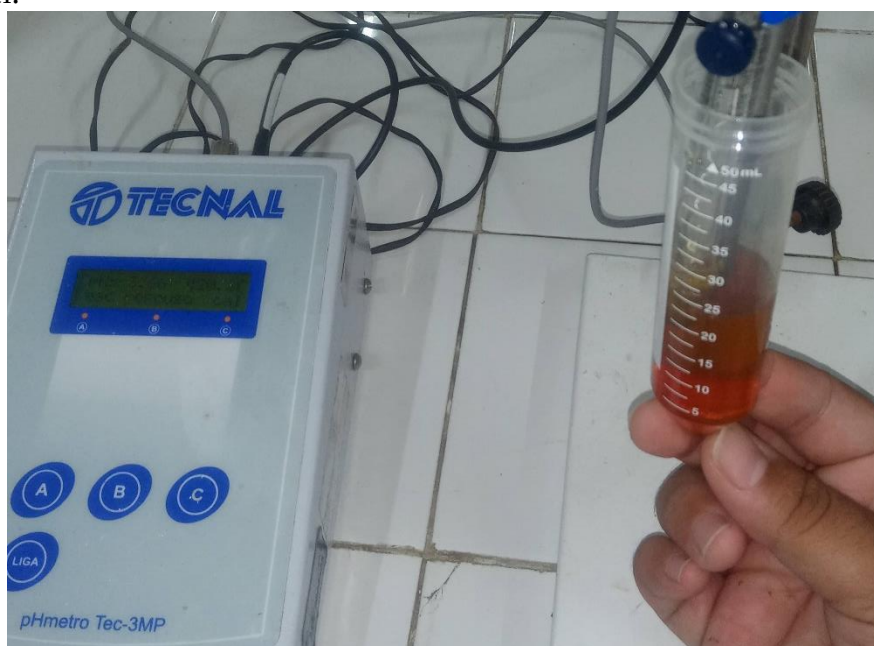
Figura 26: pHmetro TECNAL Tec-3MP, usada nas análises pH das amostras de mel, mosto e hidromel.
