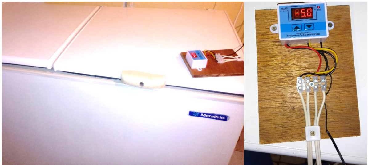
Figura 16: Freezer horizontal com termostato acoplado para controle de temperatura em -5^{\circ}\text{C} , com limite de tolerância em \pm 0,5^{\circ}\text{C} .
