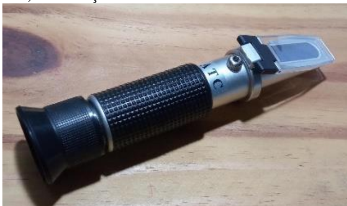
Figura 29: refratômetro portátil ATC, com escala 0-30°Brix, usado nas análises °Brix das amostras de mosto, fermentação e hidromel.
