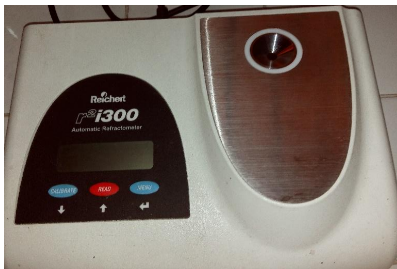
Figura 24: Refratômetro digital de bancada REICHERT R 2 I300, usado na leitura do °Brix do mel.
