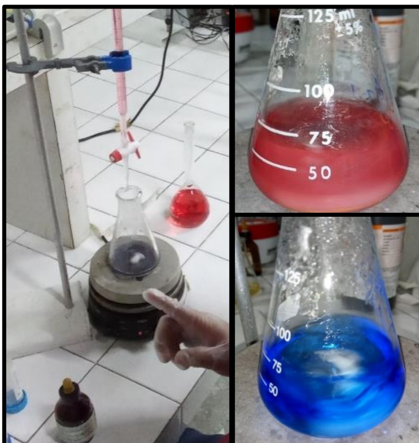
Figura 30: bureta e chapa aquecedora usadas para as determinações de acidez fixa, acidez total e açúcares redutores totais nas amostras de mosto e hidromel. À direita está sendo representada a alteração da coloração na determinação de açúcares redutores totais.
