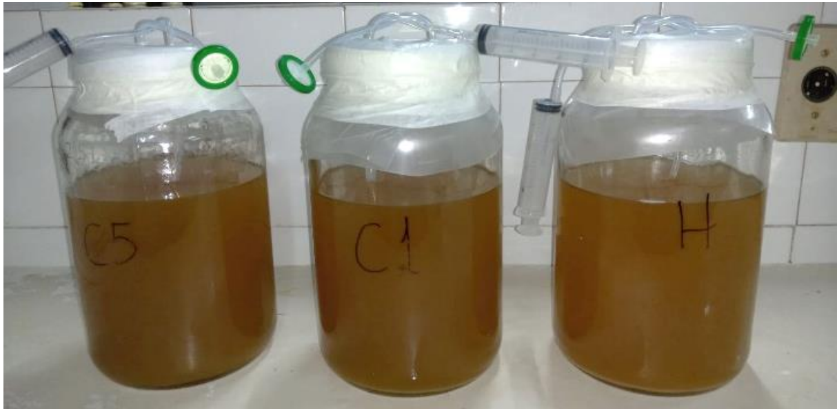
Figura 13: Formulações H, C1 e C5, já inoculadas e com fermentadores lacrados com Parafilm® e fita crepe iniciando o processo de fermentação.
