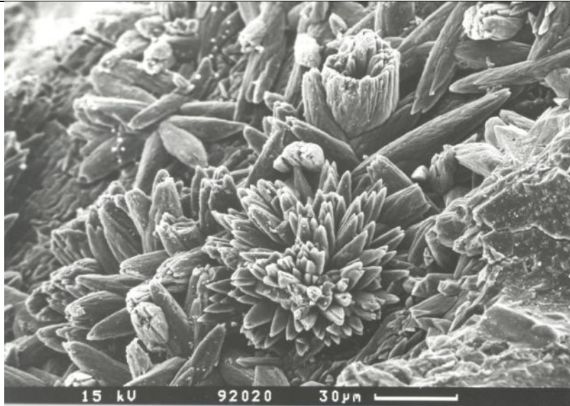
Figura 5.24: Agregados fibro-radiais, dispostos ao redor dos grãos, com dimensão, em média, de 60 µm. Amostra emersa 12, MEV.
