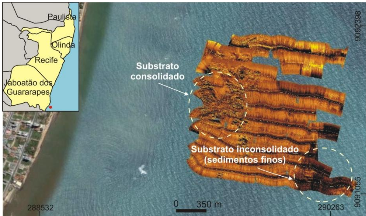
Figura 4.13: Mosaico sonográfico da orla do Município de Jaboatão dos Guararapes. Destaque para o substrato consolidado e depósitos de lama (substrato inconsolidado).
