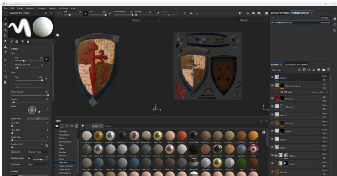
Interface do programa Substance Painter, no qual se pode observar no canto inferior da área de trabalho do software uma lista de materiais pré-prontos, porém ajustáveis, que podem ser utilizados na texturização digital.
