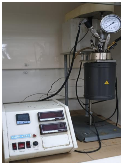
Figura 8 - Reator Parr modelo 4843 utilizado na avaliação catalítica.
