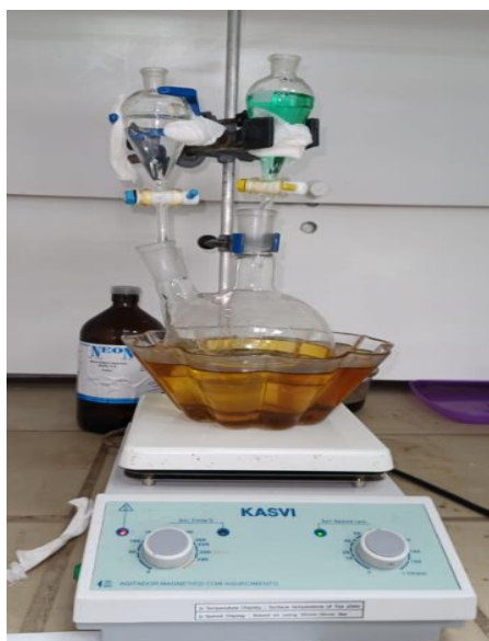
Figura 7 - Sistema para preparação dos catalisadores
