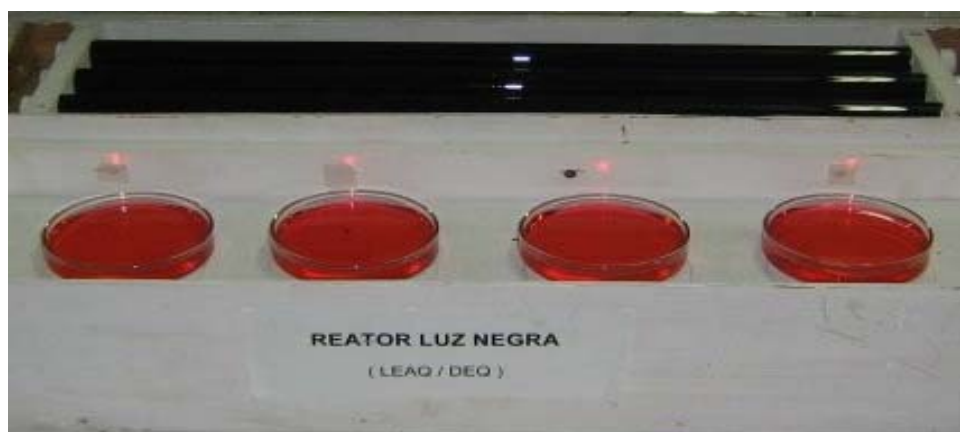
Figura 7: Sistema em batelada laboratorial usando a irradiação de Luz Negra.
