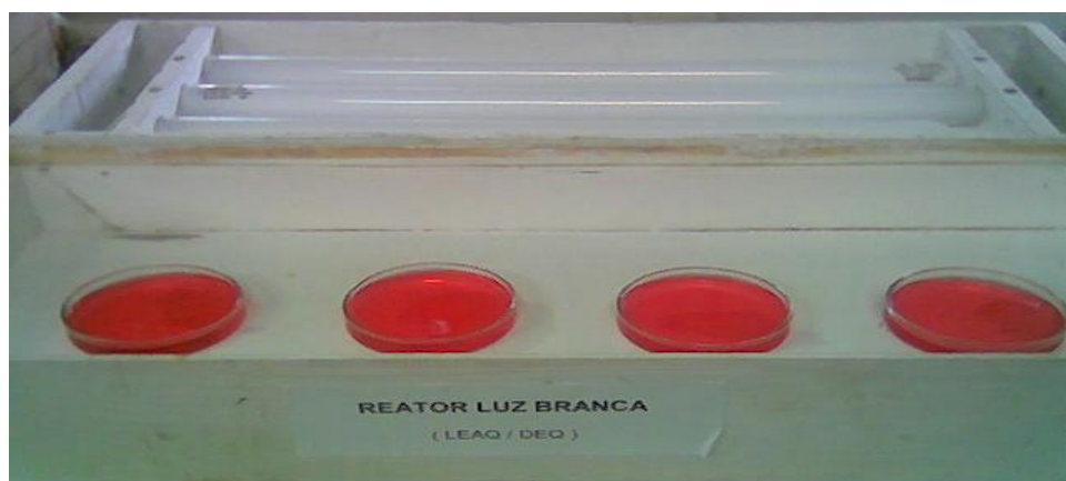
Figura 8: Sistema em batelada laboratorial usando a irradiação de Luz Branca.
