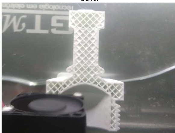
Figura 18 - Visão transversal do modelo 3D de ABS do conector frangível com preenchimento de 30%.
