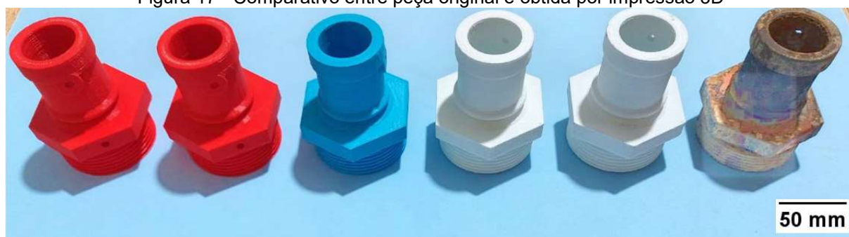
Figura 17 - Comparativo entre peça original e obtida por impressão 3D
