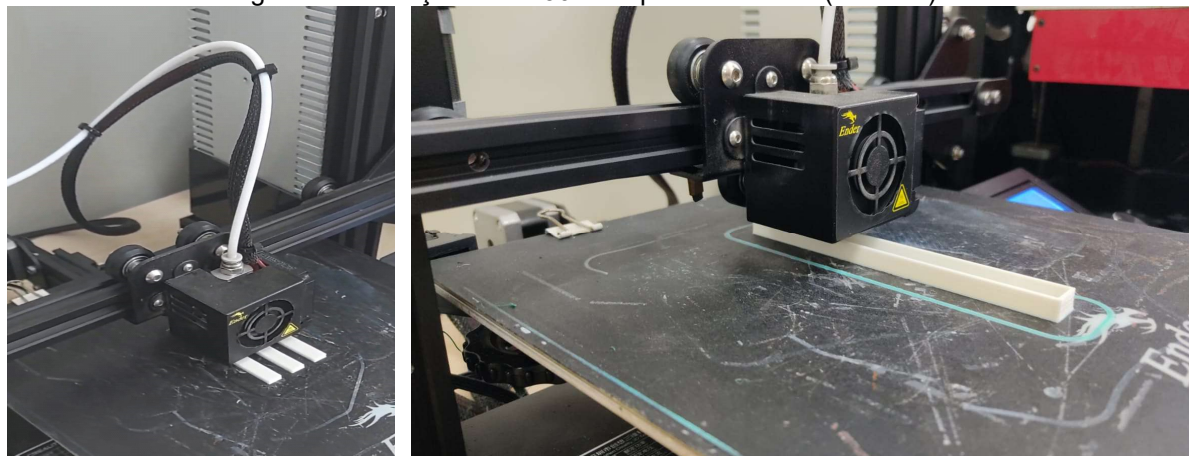
Figura 8 - Impressão de corpos de prova de PLA com preenchimento de 100% (à esquerda) e em geometria treliçada com 30% de preenchimento (à direita)
