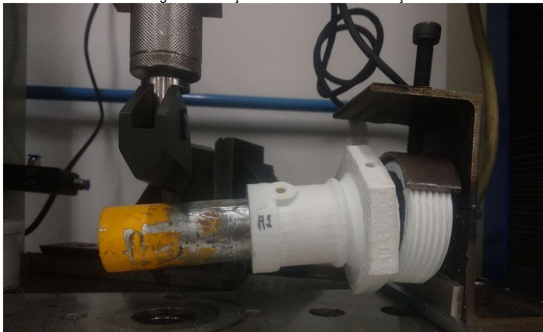
Figura 12 - Peça danificada durante a fixação
