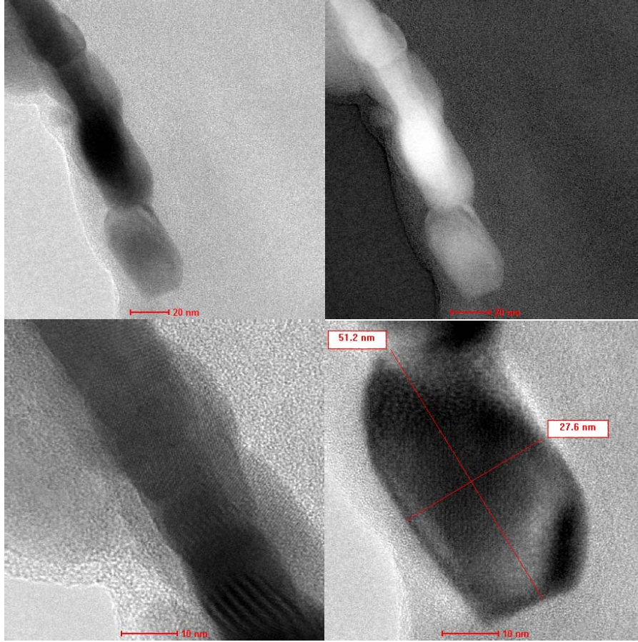
Figura 4-15. Microscopia eletrônica de transmissão mostrando a morfologia de grãos em fios de níquel amostra Ni20cTT5.
