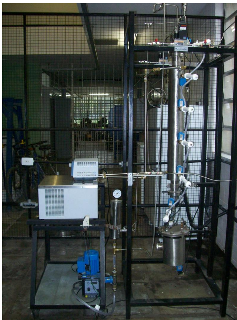
FIGURA 2.4 – Unidade de processamento catalítico contínuo em reator de leito gotejante.
