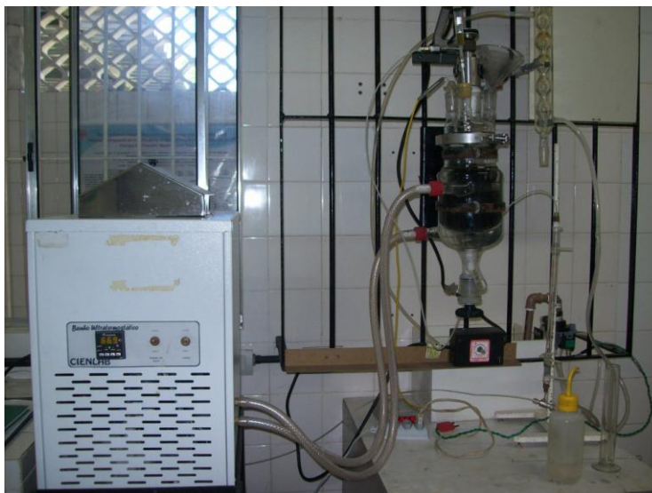
FIGURA 2.2 – Reator de mistura encamisado (direita) para reações de oxidação e banho ultratermostático (esquerda).
