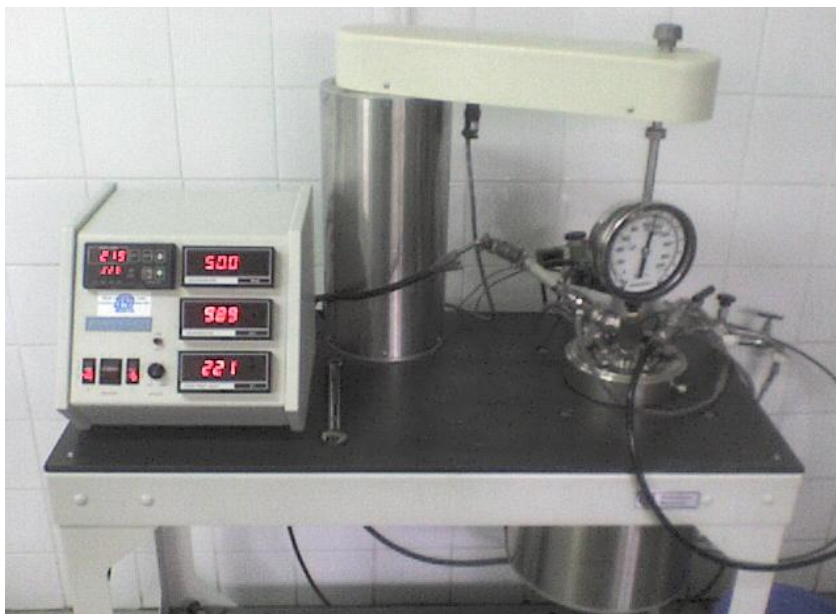
FIGURA 2.1 – Reator descontínuo de leito de lama (PARR 4531) (direita) e controlador de temperatura do tipo PID (PARR 4843) (esquerda).
