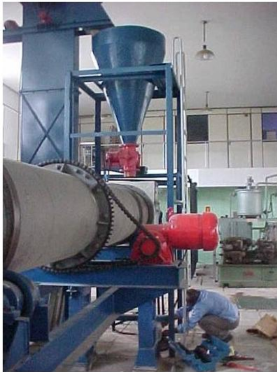
Figura 3.4 – Conjunto eletromecânico responsável pelo movimento de rotação do cilindro do forno.
