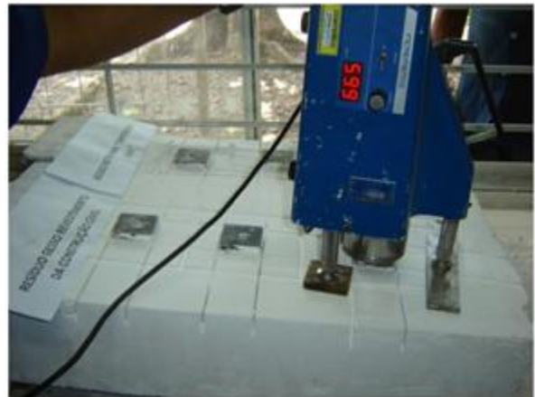
Figura 3.26 - Equipamento de medida de resistência de aderência do revestimento da pasta de gesso.
