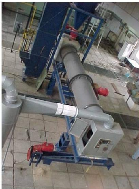
Figura 3.2 – Forno rotativo piloto para calcinação com Gás Natural – DEQ/UFPE.
