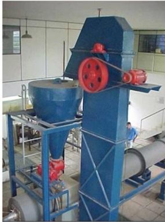
Figura 3.6 – Elevador de canecas e tremonha responsável pela alimentação de sólidos.
