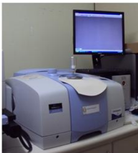
Figura 3.30 - Espectrofotômetro NIR/MID spectrum 400 da marca Perkin Elmer.
