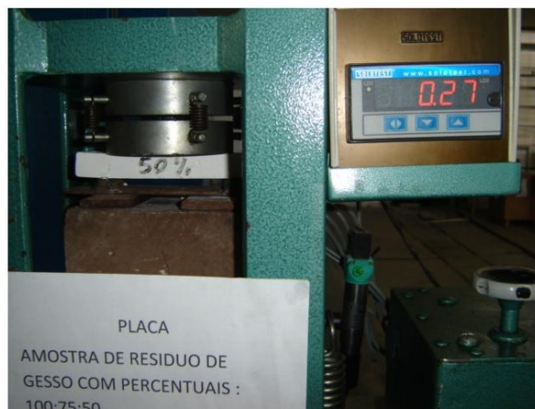
Figura 3.25 – Teste de tração a flexão em corpos de prova.
