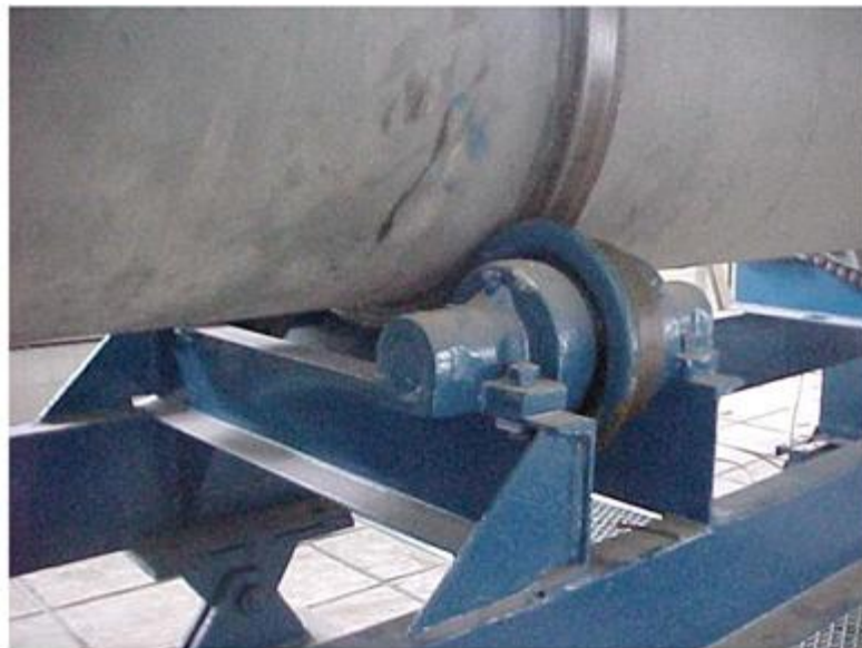
Figura 3.4 – Conjunto eletromecânico responsável pelo movimento de rotação do cilindro do forno.
