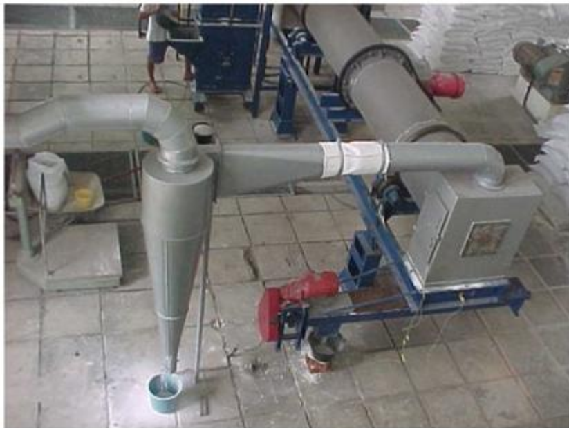
Figura 3.8 – Ciclone instalado na saída dos gases do forno rotativo piloto.
