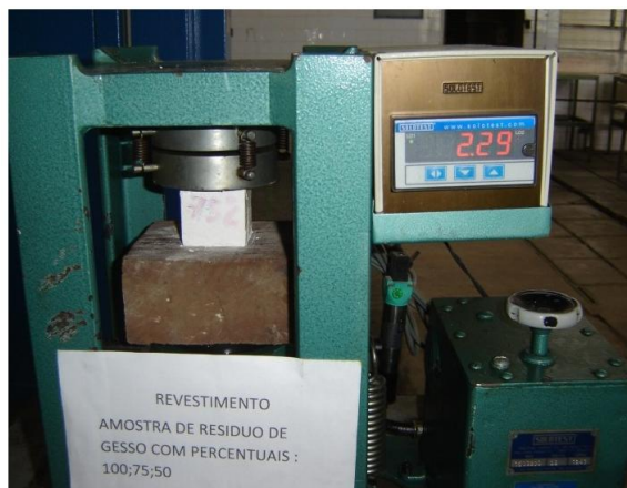
Figura 3.24 – Teste de compressão em corpos de prova.
