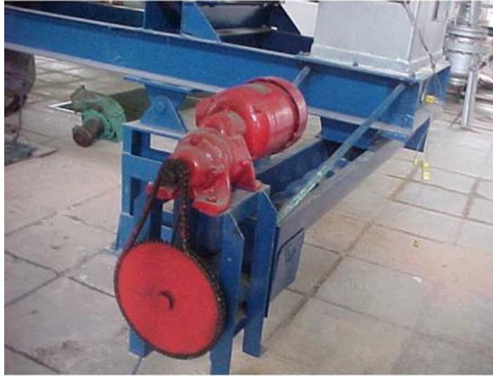
Figura 3.7 – Transportador helicoidal responsável pela coleta do gesso produzido no forno rotativo piloto.
