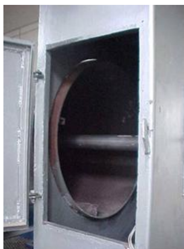
Figura 3.2 – Forno rotativo piloto para calcinação com Gás Natural – DEQ/UFPE.
