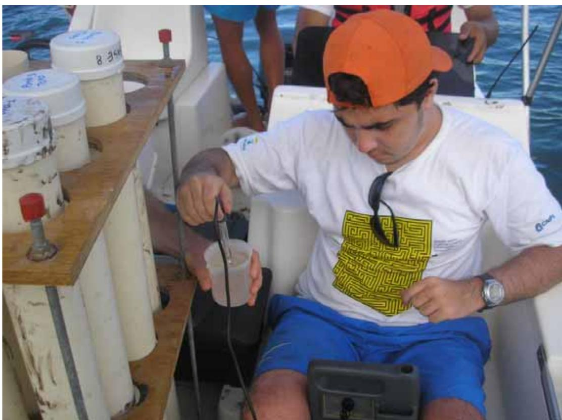
Foto 14 – Medição dos parâmetros físico-químicos da água (*in situ*) com a Sonda Multi-Parâmetro Portátil (Março/2008).
