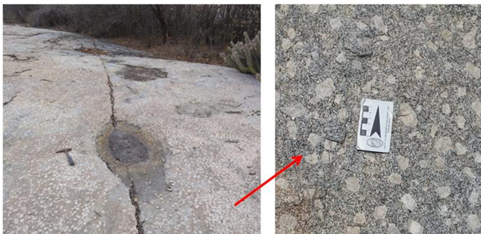
Figura: Aspecto do Granito porfirítico, com textura heterogênea de minerais máficos e félsicos de tamanhos distintos. Fonte: Acervo do autor, 2019.
