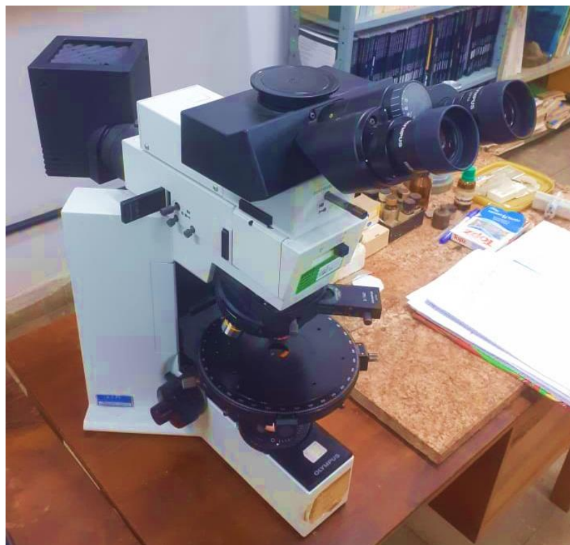
Figura 01: Microscópio petrográfico usados para identificar as propriedades das amostras do embasamento cristalino das áreas estudadas.
