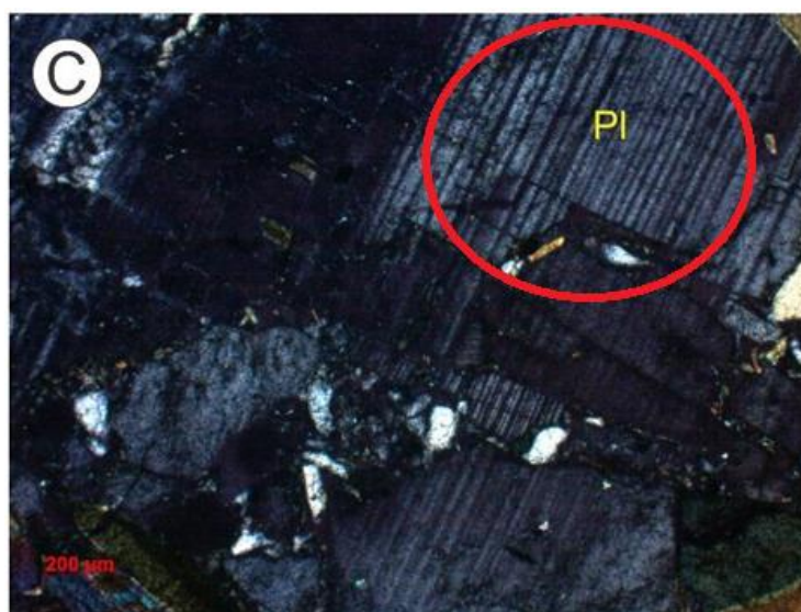
AMOSTRA A1BMD. (C) Plagioclásio fraturado e com deslocamentos na geminação polissintética – NC. Fonte: O autor, 2022.
