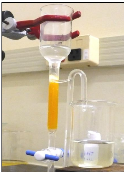
Figura 12. Extração do Pb-210 pela coluna de troca iônica
