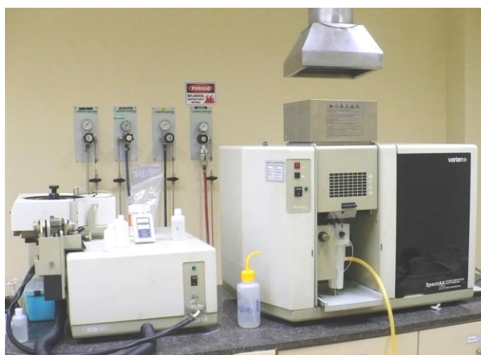
Figura 11. Espectrofotômetro de absorção atômica utilizado para análises geoquímicas
