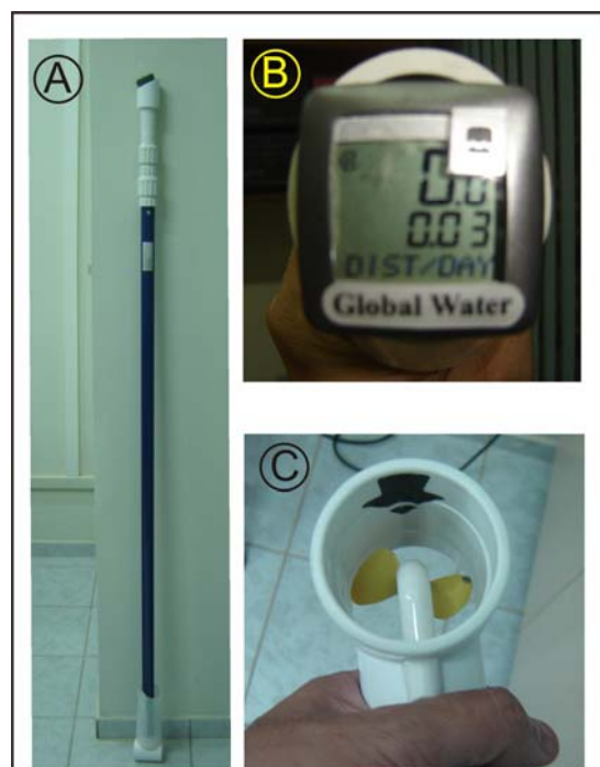
Figura 4.19 - Detalhe dos componentes do micromolinetes: a) visão geral do equipamento, b) visor com informações de velocidade, que fica localizado na parte superior; c) hélice com a seta indicando o sentido de fluxo da água, localizado na parte inferior.
