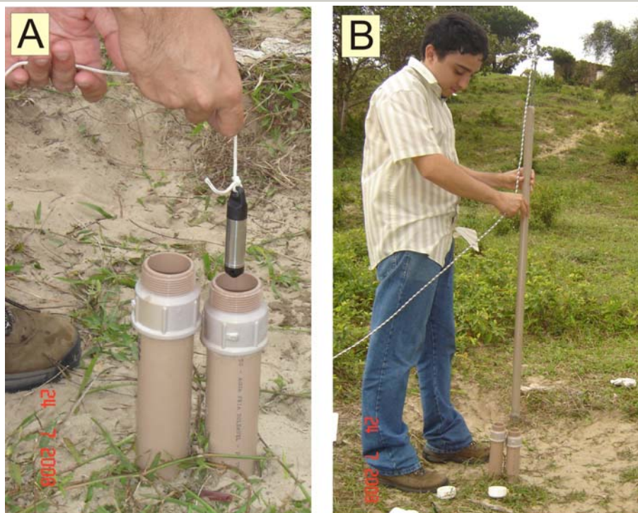
Figura 4.8 - Detalhe da instalação do sensor de pressão (A); e momento de introdução do slug no poço piezômetro (B).
