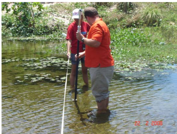
Figura 4.20 - Procedimento de medição do volume de descarga do rio Doce.
