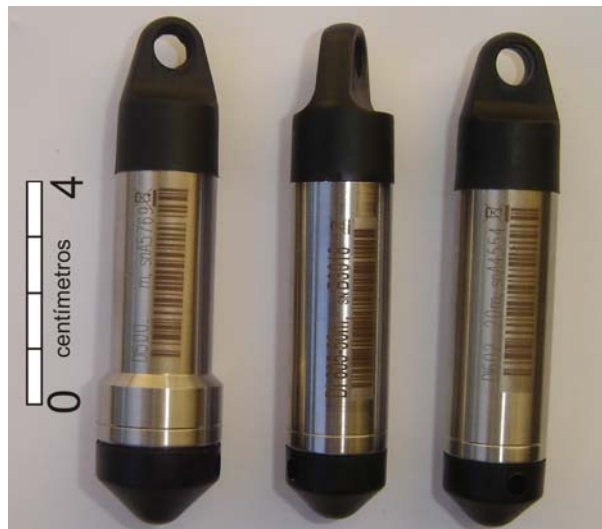
Figura 4.6 - Diferentes tipos de sensor de pressão ( data logger ). Da esquerda para direita, medidor de variação de pressão atmosférica, medidor para coluna d'água máxima de 50 m e medidor para coluna d'água máxima de 20 m.
