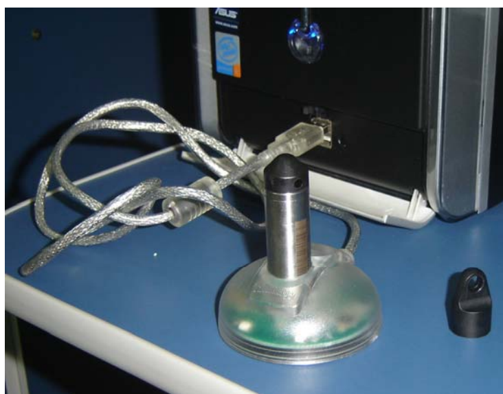
Figura 4.9 - Mecanismo de conexão entre o sensor de pressão ( data logger ) e computador, via cabo USB.
