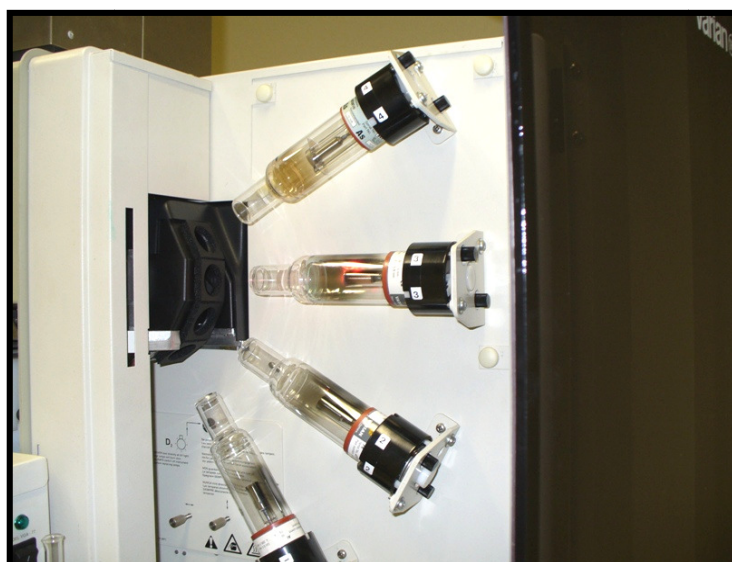
Figura 38 - Lâmpadas de cátodo oco utilizada no espectrômetro de absorção atômica (AAS).
