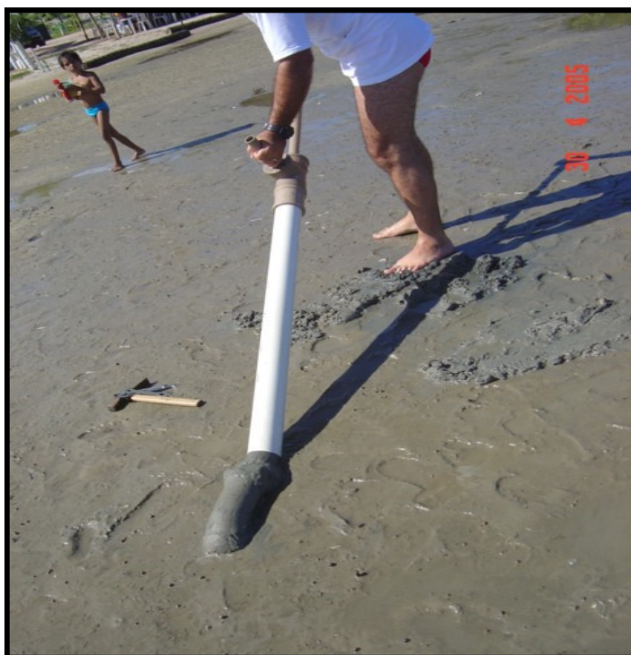
Figura 34 – Testemunhador adaptado por Jorge Luiz Lopes.
