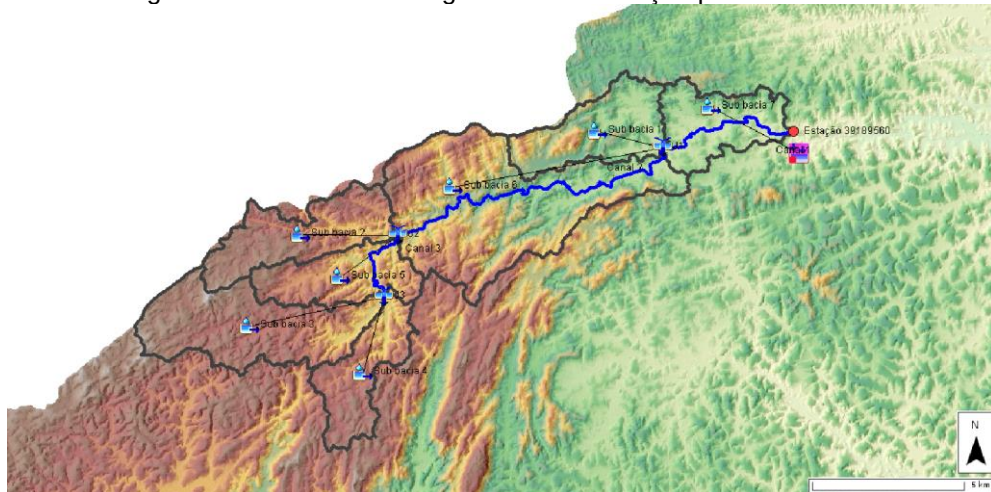
Figura 35 – Modelo hidrológico com distribuição por sub-bacias.
