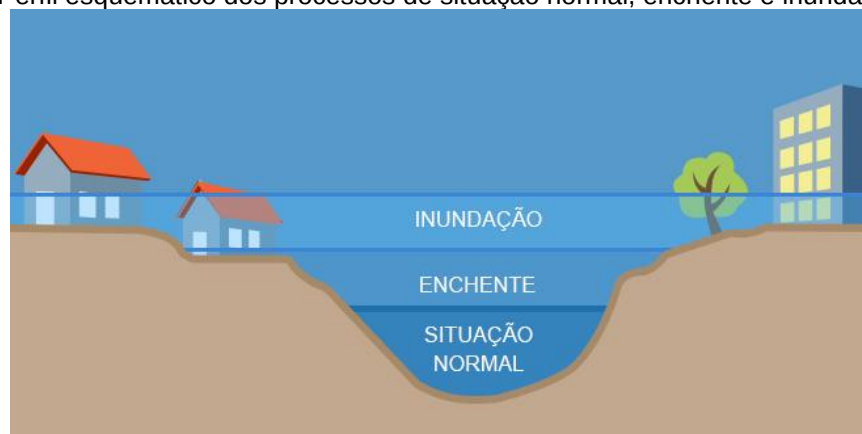
Figura 3 - Perfil esquemático dos processos de situação normal, enchente e inundação.
