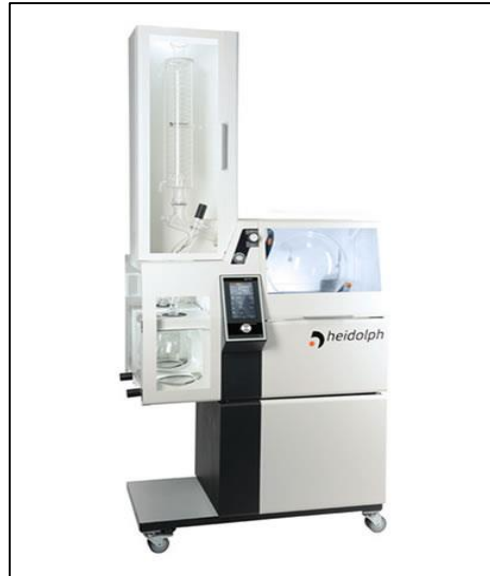
Figura 5 - Rotaevaporador Hei-VAP Industrial - vidraria Shorty R.
