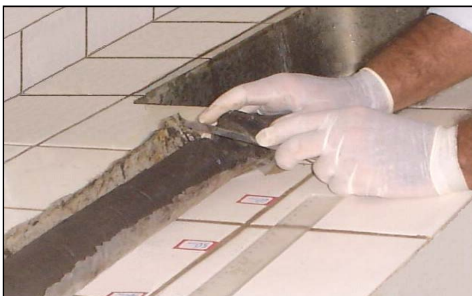
Figura 16 – Seccionamento de testemunho de perfil sedimentar em laboratório.
