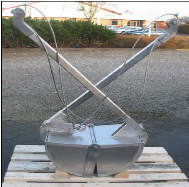
Figura 17 – Amostrador pontual tipo Van-Veen.
