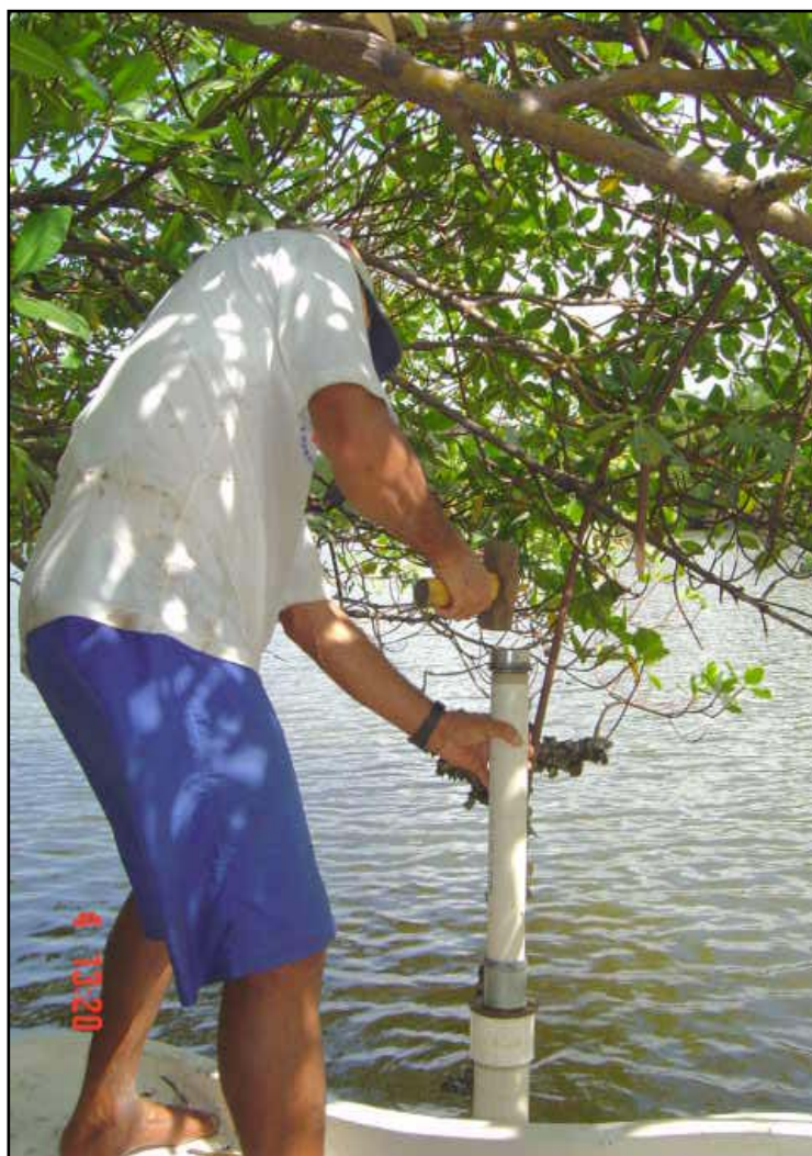
Figura 20 - Amostragem à percussão de perfil sedimentar
