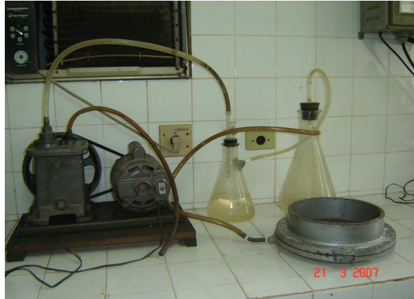
Figura 14 – Filtro a vácuo Primar (deslocamento de 48 L/min) com dois kitassatos acoplados em seqüência, e um filtro a vácuo de tela metálica B8A Denver Lab Filter.
