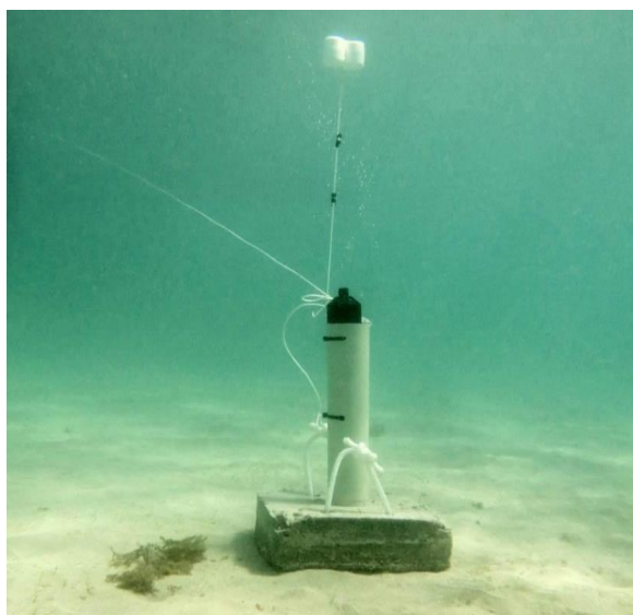
Figura 2 - Receptor acústico omnidirecional (VR2W-69kHz, VEMCO) instalado sobre substrato arenoso. Foram utilizadas poitas de cimento para fixação e boias circulares para localização na superfície.
